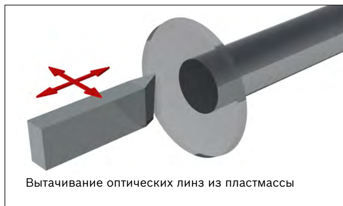
Высокоточная обработка на токарном станке
