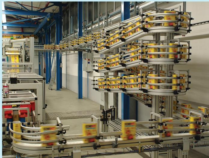
Для обеспечения гигиенических требований фармацевтических и пищевых производств конвейерные системы имеют исполнение из нержавеющей стали. Конвейерные системы Бош Рексрот позволяют решить задачи по транспортировке, подъему и опусканию продукции, обеспечивают реверсивное движение, задачи буферизации на базе спиральных систем, задачи вертикального подъема продукции в условиях ограниченных габаритов.
