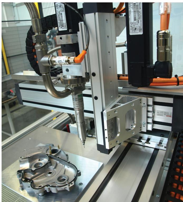
на базе зубчатоременной передачи, ШВП или линейного двигателя прямого действия. Широкий диапазон типоразмеров позволяет скомпоновать оптимальную систему для решения каждой конкретной задачи. Система комплектуется необходимыми дозирующими системами, контроль работы которых организуется при помощи АСУ станции. На уровне системы управления реализуется точное контролируемое контурное движение дозирующего устройства с реализацией пропорциональной подачи вязкой субстанции:
